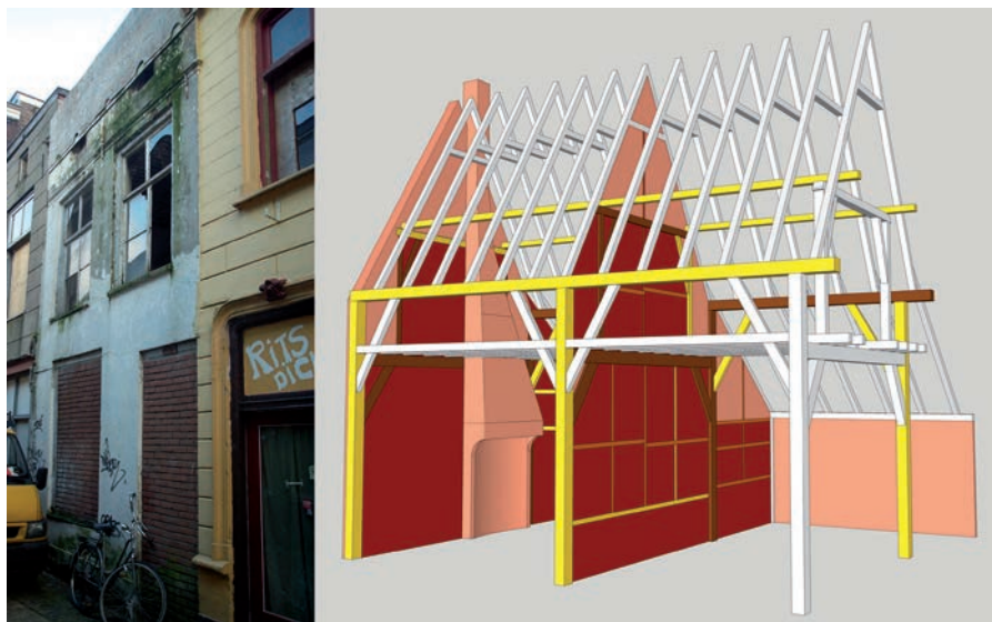
Afbeelding 5. De voorgevels in 2004 en de reconstructie van het houtskelet en de vakwerkwand tussen Schilderstraat 9 en 11. Bruin en rood is aangegeven wat aan oorspronkelijk hout en baksteen is aangetroffen, geel en roze wat aan de hand daarvan kan worden gereconstrueerd en wit wat vermoedelijk aanwezig is geweest (foto Erfgoed 's-Hertogenbosch, tekening auteur).
